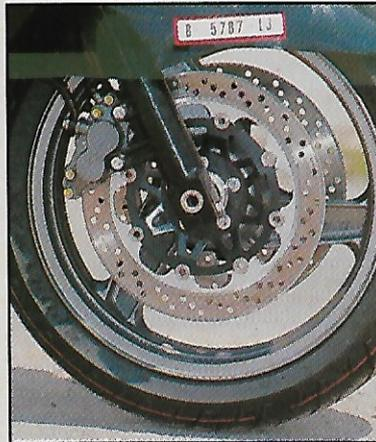
*La frenada conseguida por los dos discos Tokico de 310 mm. es muy efectiva con potencia, dosificabilidad y ausencia casi total de bloqueos... aunque gran parte del mérito debe anotarse a los pegajosos Dunlop SportMax.*
