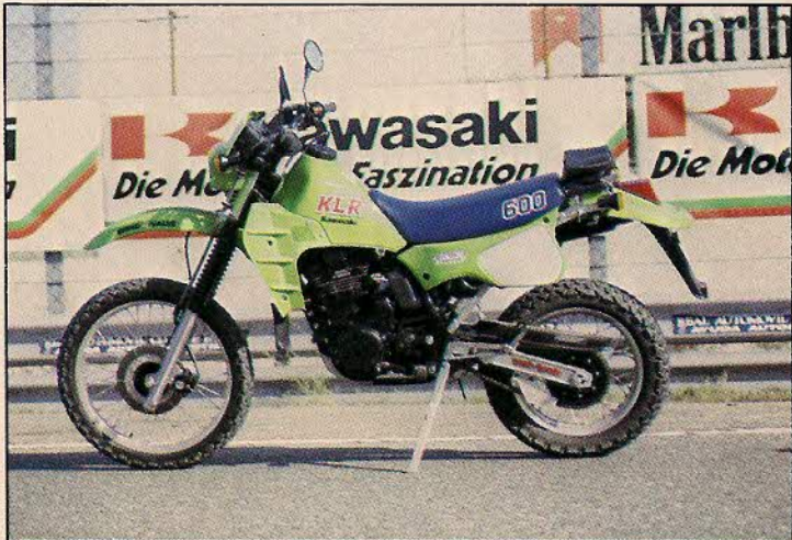
La LTD 454 refrigerada por agua y totalmente Chopper también fue presentada a la prensa en el Jarama, al igual que la KLR 600 trail, con motor cuatro tiempos refrigerado por agua y con arranque eléctrico.
