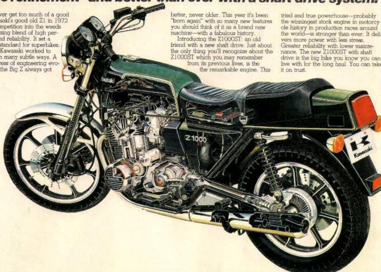
mentos elásticos. Por otra parte, la transmisión primaria se realizaba por medio de engranajes rectos en vez de cadena, y el engrase era por medio de aceite en el cárter (la Honda lo hacía por cárter seco). Otra diferencia importante se encontraba en el anclaje del cigüeñal a la bancada y las bielas al cigüeñal, que se realizaba por medio de rodamientos de agujas, como las MV Agusta, en contraposición a la Honda que utilizaba el sistema automovilístico de casquillos antifricción.
