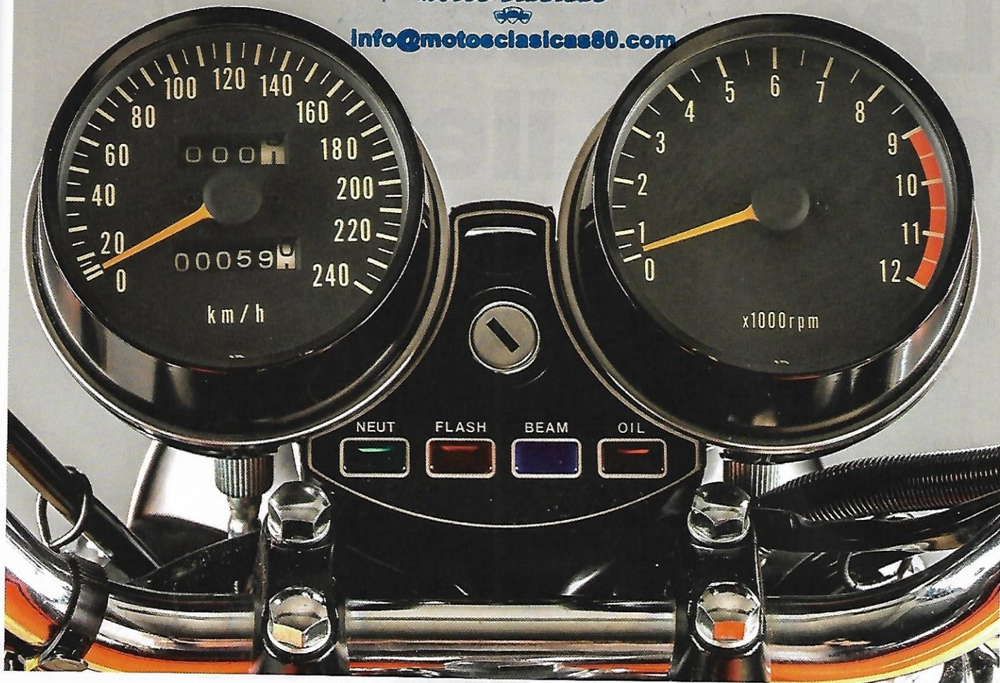
La instrumentación estaba formada por dos esferas analógicas Nippon Denso para tacómetro y velocímetro, con los chivatos entre estas.
