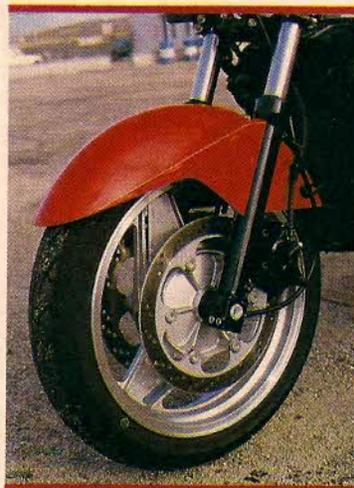
La rueda delantera es de 17 pulgadas, con llanta de núcleo hueco. Los dos discos son de 300 mm. con pinzas BAC de doble pistón paralelo de distinto diámetro.
