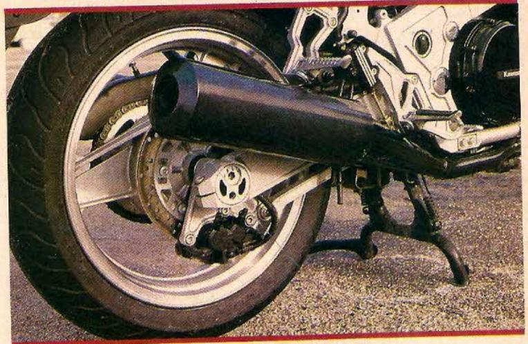
El basculante es de aluminio rectangular. El tensado de la cadena se realiza mediante una práctica excéntrica. El freno de disco es de 250 mm. con pinza flotante de doble pistón paralelo BAC.
