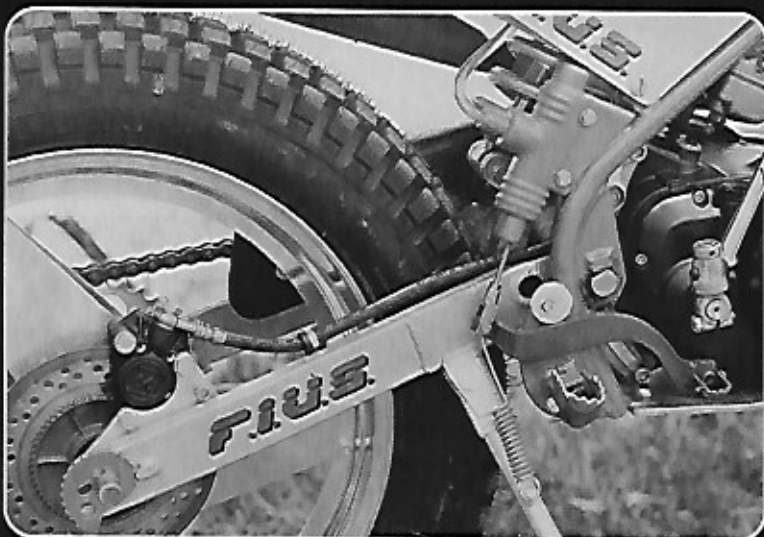
En las dos imágenes superiores vemos por los dos lados el "tren trasero". Un basculante robusto en acero, la cadena con guía de rodillo por arriba y tensor por abajo, protege-cadenas... y en el lado derecho la bomba del freno trasero protegida por una carcasa de plástico, y el caballete o pata de cabra.
