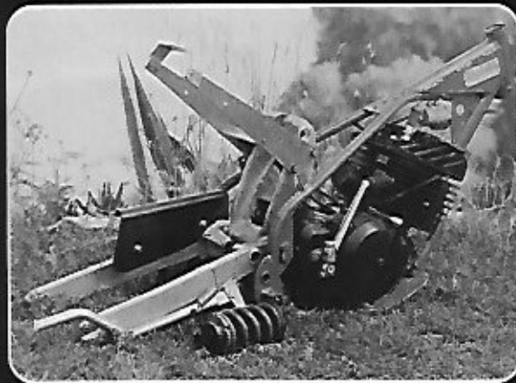
erentes aspectos del chasis de la nueva Merlin. Puede apreciarse el 'colin' trasero que sirve tan sólo de sujeción para el guardabarros; también la simplicidad del entramado de tubos, el aspecto robusto del basculante y el pequeño amortiguador único de la suspensión trasera —colocado al lado del chasis, en el suelo—. El conjunto es compacto y homogéneo, revolucionando completamente el concepto de bastidor de la anterior Merlin.
