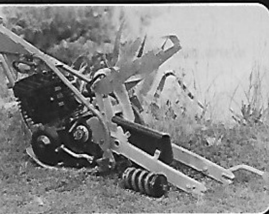
erentes aspectos del chasis de la nueva Merlin. Puede apreciarse el 'colin' trasero que sirve tan sólo de sujeción para el guardabarros; también la simplicidad del entramado de tubos, el aspecto robusto del basculante y el pequeño amortiguador único de la suspensión trasera —colocado al lado del chasis, en el suelo—. El conjunto es compacto y homogéneo, revolucionando completamente el concepto de bastidor de la anterior Merlin.
