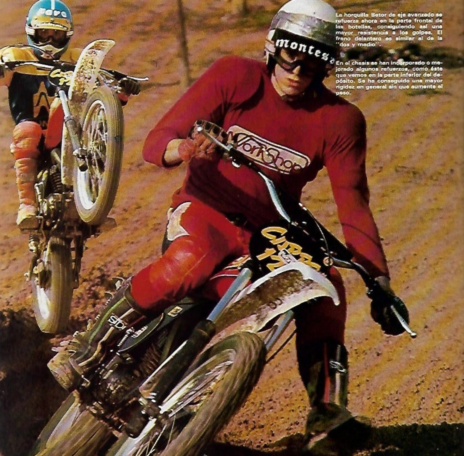
La horquilla Betor de eje avanzado se refuerza ahora en la parte frontal de las botellas, consiguiendo así una mayor resistencia a los golpes. El freno delantero es similar al de la "dos y medio".
