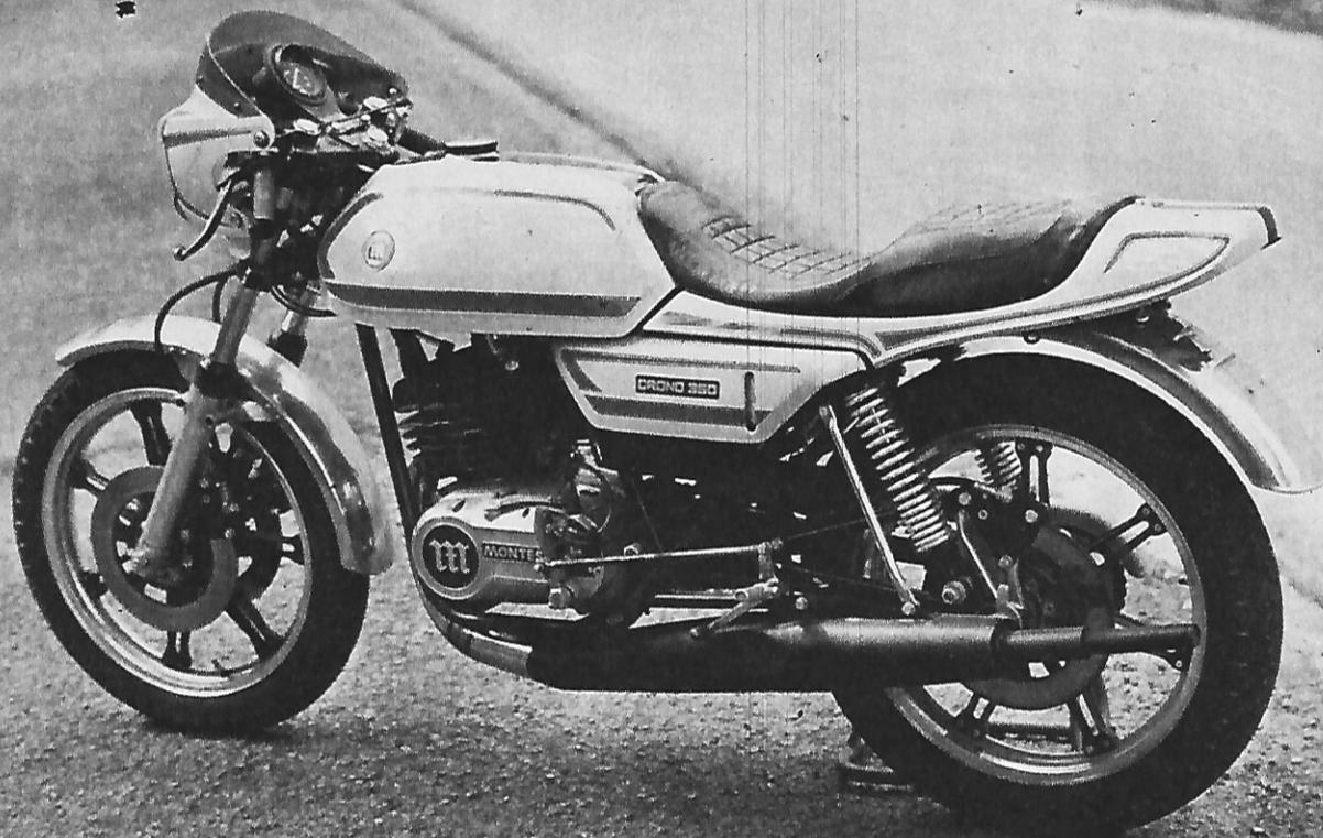
El doble freno delantero se muestra excesivo, haciendo difícil la correcta dosificación de la frenada.
