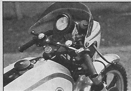
Ambos pilotos se mostraron partidarios de poner un puño de acelerador rápido y de probar distintos reglajes de altura e hidráulico en la horquilla para enmascarar los vicios de dirección.
