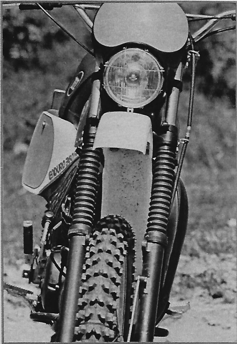
El faro de tamaño algo mayor que el del anterior modelo para cumplir las normas de tráfico alemanas, queda fijado por unos anclajes de goma que ajustan perfectamente. La placa lateral derecha sobresale excesivamente, molestando cuando hay necesidad de «remar» ampliamente.
