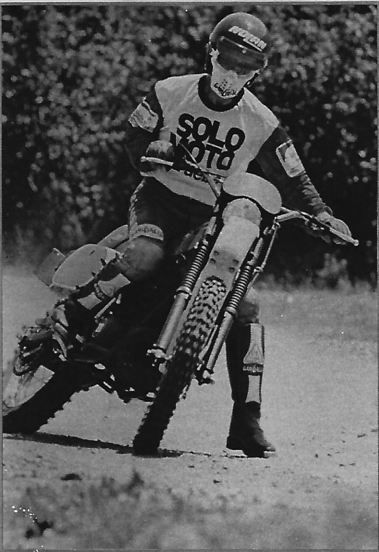
Una vez «aclimatado», las mordazas te permiten buenas apuradas de frenada. El freno trasero tiende a calentarse y, por tanto, a perder efectividad cuando se abusa de él en disminuciones fuertes de velocidad; por ejemplo, la frenada de pasar de carretera a camino ancho o a un desvío de trialera.
