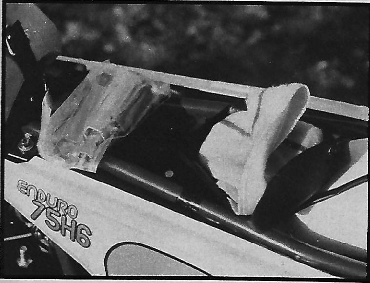
Levantando el asiento, sujeto mediante dos tirantes elásticos, tendremos acceso al filtro del aire y a una bandeja portaobjetos que contiene una correcta dotación de herramientas.
