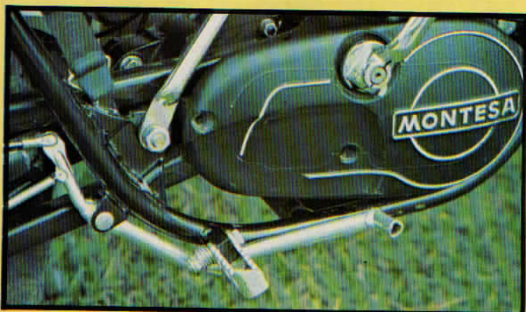
La palanca del freno trasero es mucho más larga, hecha a base de tubo. Tampoco es plegable.
