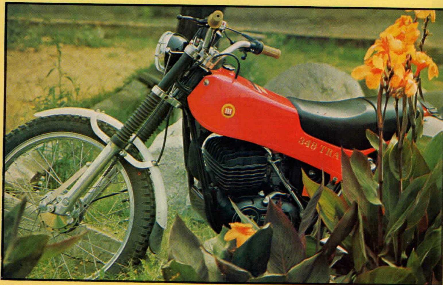
La palanca del freno trasero es mucho más larga, hecha a base de tubo. Tampoco es plegable.
