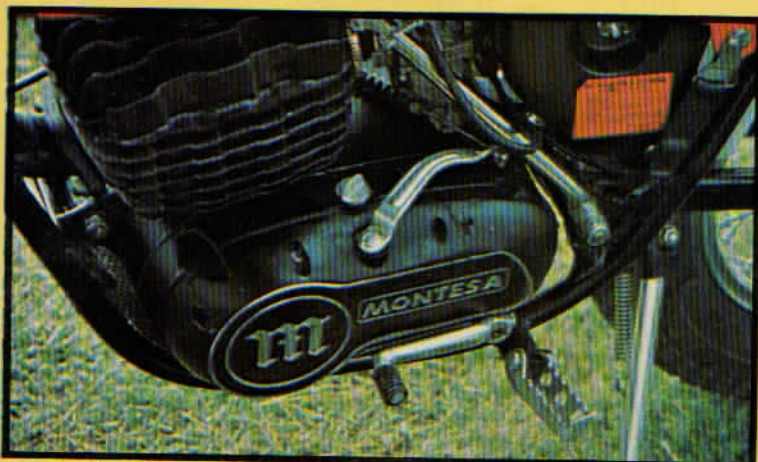
Las estriberas van en este modelo más adelante y abajo que en la máquina de trial. La palanca del cambio no es articulada.
