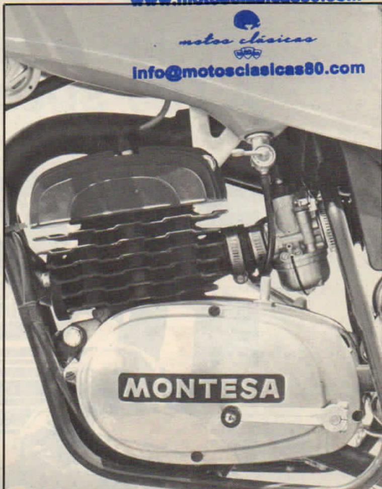
Detalle del nuevo motor en el que se acorta la biela y se adopta el escape central. El carburador es un Amal con starter.
