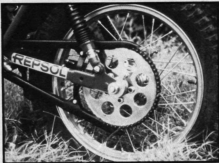
Una observación más detenida nos permite advertir los elementos particulares de esta 80. Por ejemplo, la corona trasera de grandes dimensiones, destinada a acortar la relación final de transmisión.
