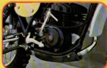
El motor por el lado derecho. Puede verse la palanca del freno... ¿frágil?, y el protector del escape.
