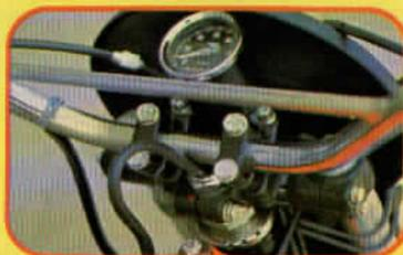
Detrás de la máscara queda el reloj velocímetro-cuentakilómetros, que recoge los datos de la rueda trasera, donde las flexiones del cable son mucho menos notables.
