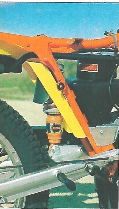
*Amortiguador Telesco para el monoshock.*
