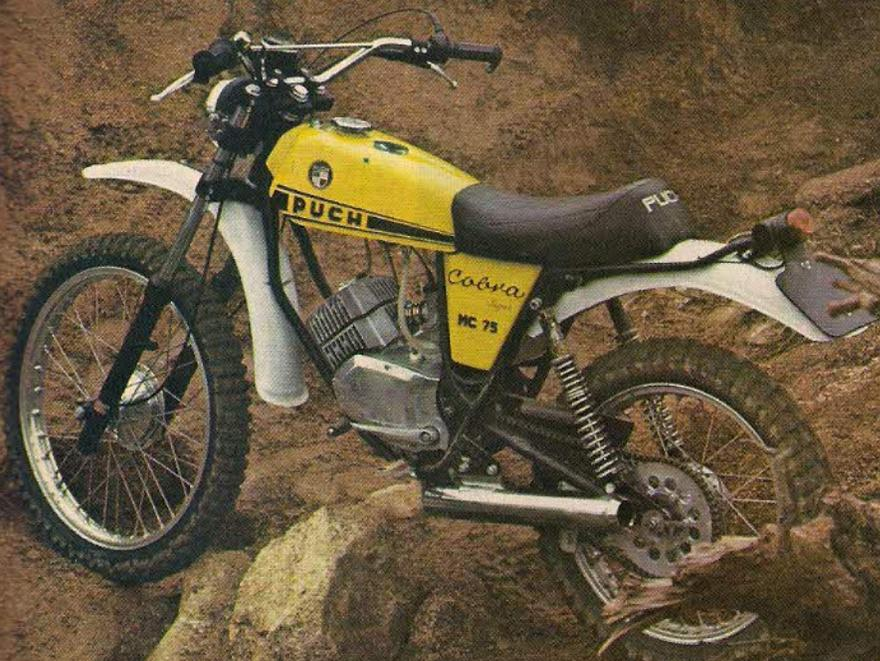
fabricada por Betor es del tipo "eje adelantado", con botellas negras y un recorrido total de 180 mm. Detrás se completa el conjunto con unos amortiguadores Betor gas de 160 mm de recorrido.
