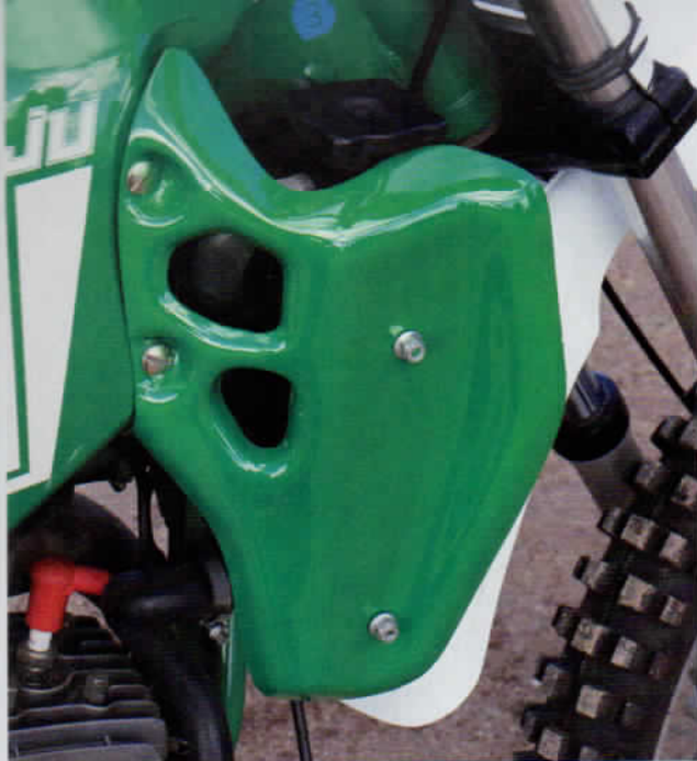
Las MR Competición montan dos radiadores, situados a izquierda y derecha del chasis y protegidos por sendos aletines de plástico. La cámara a mano y las marcas rojas en las llantas para localizar la válvula rápidamente en caso de pinchazo eran imprescindibles en competición.
