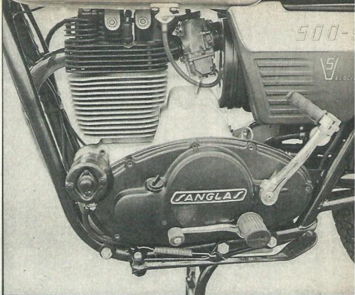
Dos vistas laterales del motor y sus nuevas tapas de encendido y de distribución primaria. Las tres Sanglas V-5 que hemos probado hasta la fecha han sido estancas de cárteres, pero se ha escapado aceite por el desvaporizador. Una de las motos probadas en Gran Bretaña tenía desconectado el tubo de desvaporizador entre los cárteres y el filtro de aire, y ésta fue precisamente la Sanglas que «no sudaba» ni una gota de aceite por ningún lado, aun después de rodar un par de horas en carretera a 130 km/h.
