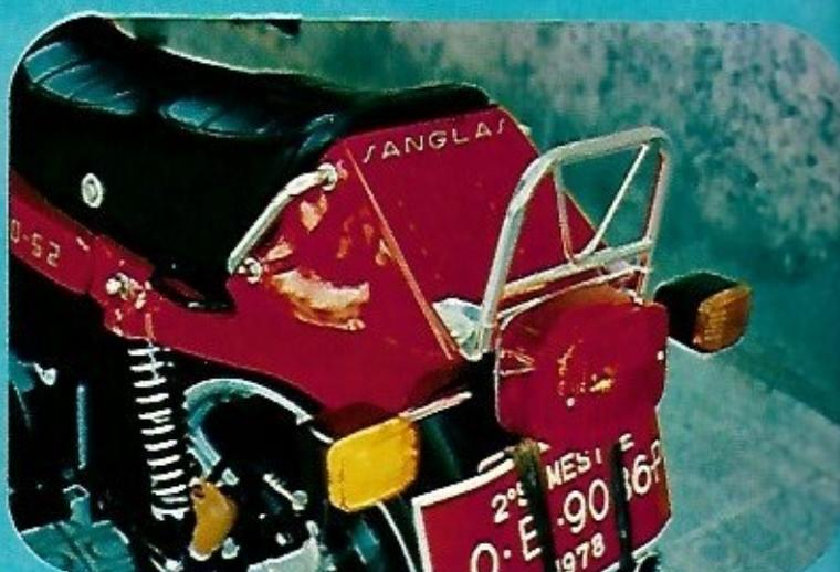
Levantando el asiento tendremos acceso al sistema eléctrico, sobre el que va una bandeja portaherramientas. Además, el elegante colín es hueco, y dentro de él se pueden colocar multitud de cosas.
