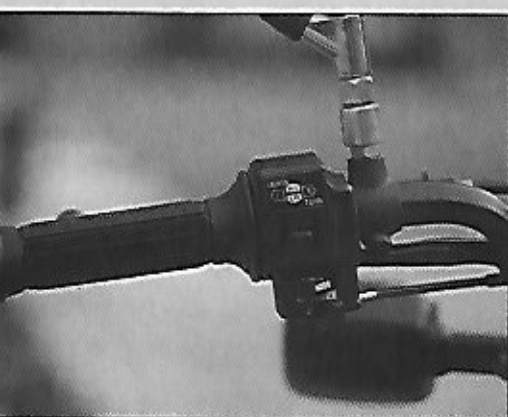
Mandos completos muy al estilo «made in Japan» con el mando del aire situado bajo la piña izquierda.
