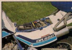
Gran transportín en fundición de aluminio y doble salida de silenciosos dan un inmejorable aspecto a la parte posterior.
