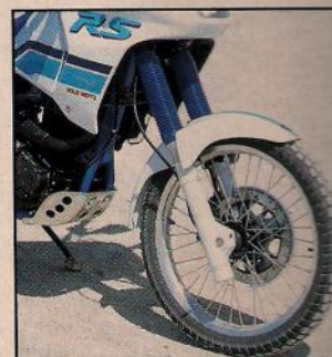
La horquilla delantera ha pasado a ser de 41 mm. de grosor de barras y su funcionamiento es excelente.
