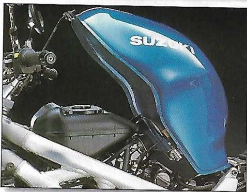
El depósito de combustible bascula para acceder fácilmente a la caja del filtro del aire.
