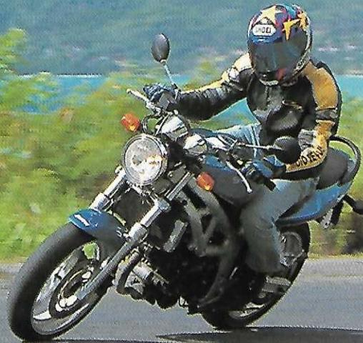
El chasis es multitubular de aluminio, con el motor suspendido, como en la TL 1000 S.
