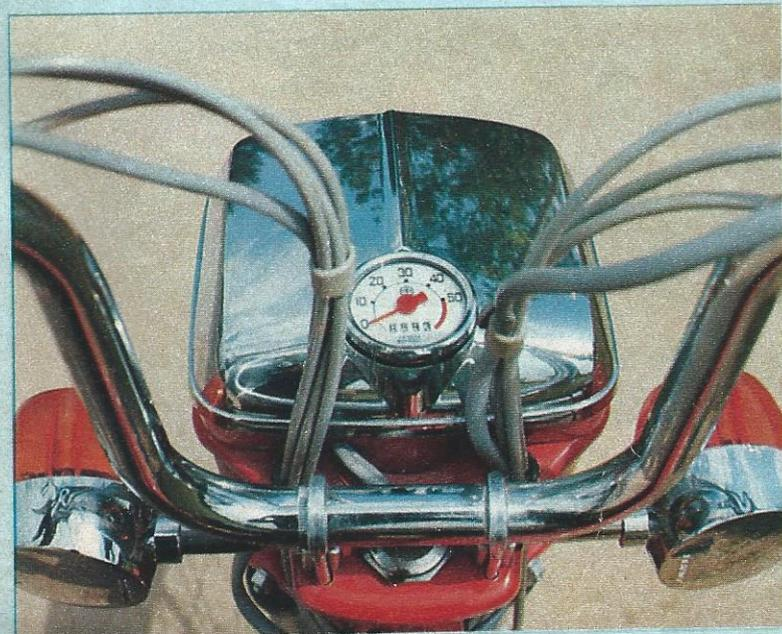
En el faro se ha incorporado un reloj con velocímetro y cuentakilómetros. En la foto se puede apreciar el juego de intermitentes delantero.
