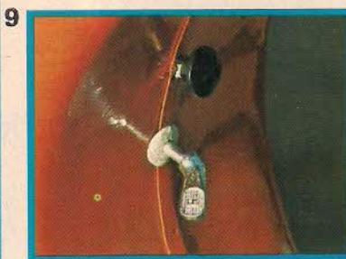
nexiones, cables, fundas, etc., queda perfectamente escondido dando una extraña sensación de limpieza... más cercana del automóvil que de la moto. Los cables que van hacia el motor van alojados por dentro del chasis, en una especie de columna central.
