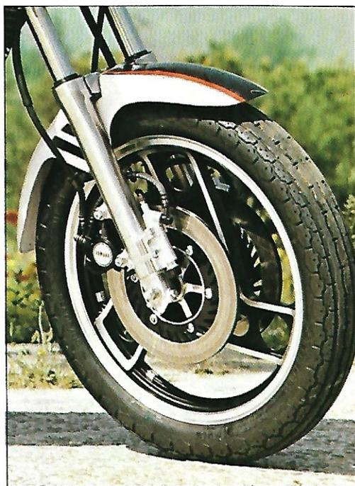
*El equipamiento de la XJ es de primerísima calidad y eficacia: relojes con indicador de nivel de gasolina, suspensiones oleoneumáticas, frenos autoventilados y sistema anti-dive hidráulico en la botella derecha de la suspensión delantera.*
