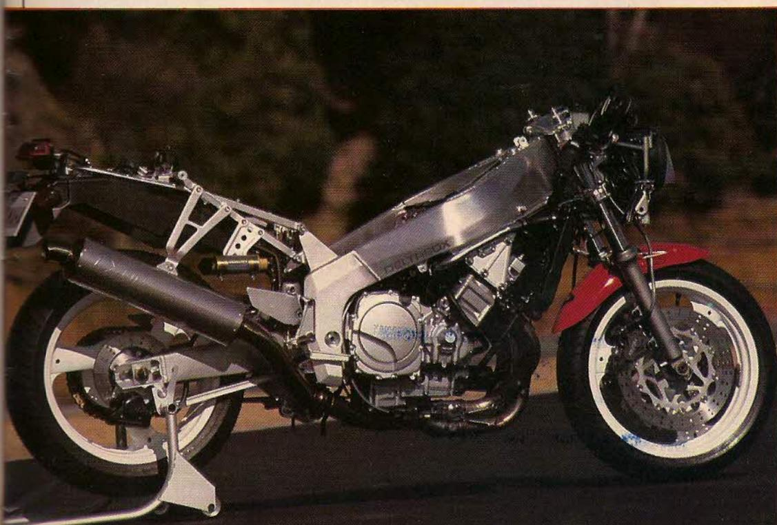
conseguir más r.p.m., mejor rendimiento de la admisión y del escape, menos rozamientos, más compacidad. Los medios: cuatro cilindros, supercuadrado (72 x 46 mm.) que permite 5 válvulas más grandes (+2 mm. admisión; +1,5 mm. escape), cilindros menos inclinados (-5° con respecto a la FZR 750), pistones de dos aros, bielas en aleación de titanio, cigüeñal pequeño y ligero.
