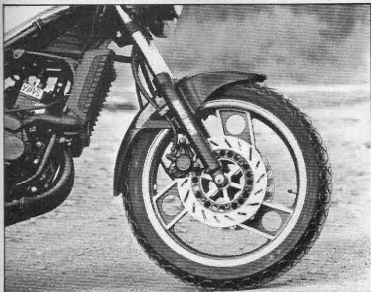
La suspensión delantera posee el sistema Variable Damper, para hacer progresivo el hundimiento de la horquilla.
