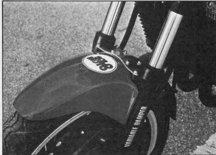
El guardabarros delantero es aerodinámico. Las dos botellas de la horquilla están sujetas entre sí por un puente de aluminio.
