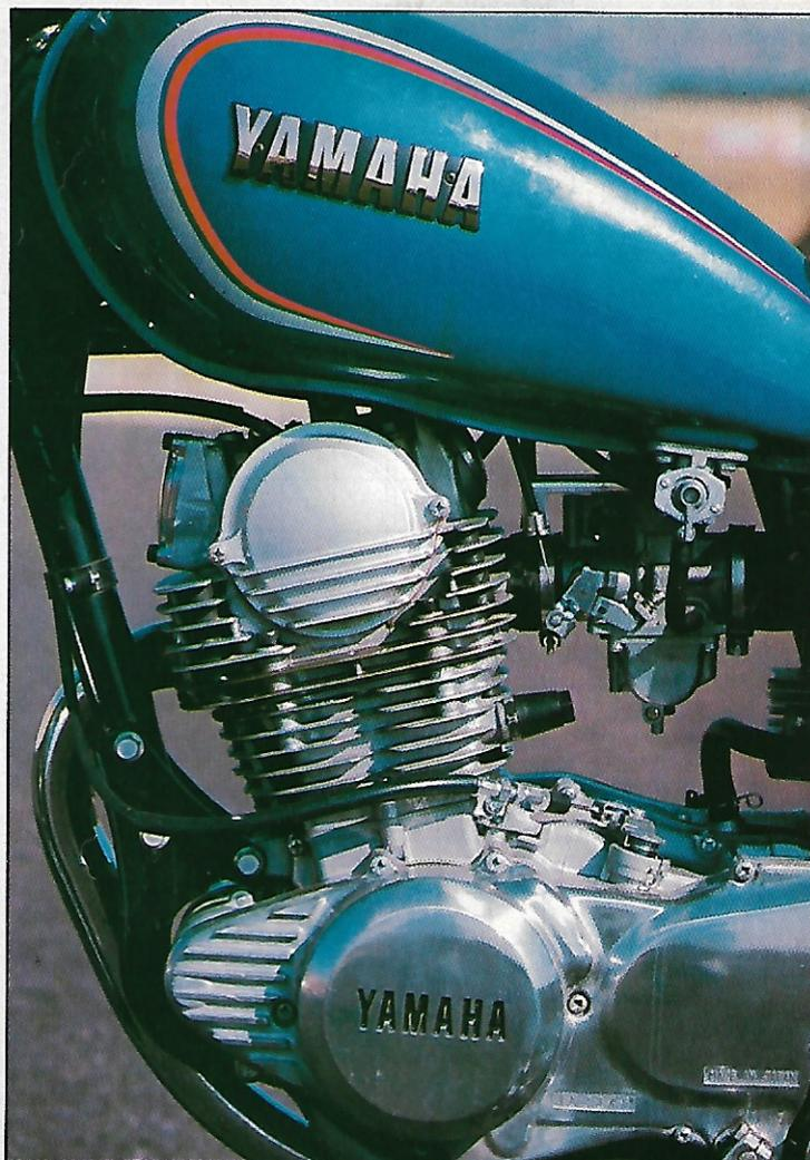
El motor de la Yamaha es exactamente el mismo que se utilizó en la anterior versión chopper. En la foto de la izquierda podéis ver una práctica ventanilla en la parte inferior izquierda para controlar el nivel del aceite. La «protuberancia» situada tras el cilindro en la foto de la derecha es un tensor para la cadena de distribución; para su tensado debemos previamente extraer el capuchón (sale a rosca).
