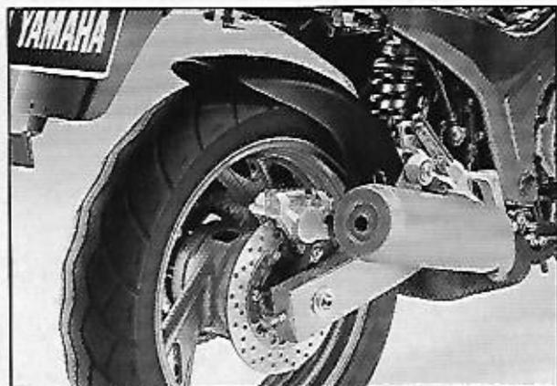
La rueda posterior es de 17 pulgadas, neumático de perfil bajo 100 x 100 de asfalto, freno de disco de 245 mm., basculante rectangular, un silencioso por cada costado,...
