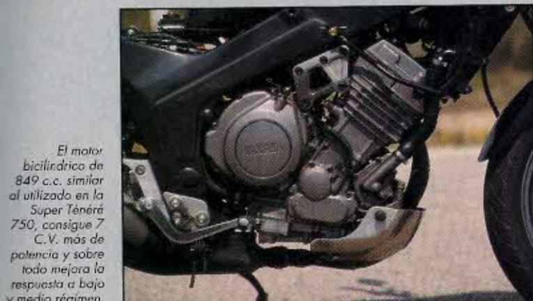
El motor bicilíndrico de 849 c.c. similar al utilizado en la Super Ténéré 750, consigue 7 C.V. más de potencia y sobre todo mejora la respuesta a bajo y medio régimen.
