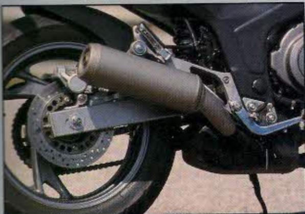
La suspensión trasera equipa un monoamortiguador progresivo sin bieletas, regulable en precarga de muelle y extensión hidráulica. Guardabarros trasero ceñido a la rueda y un escape de configuración dos en uno.
